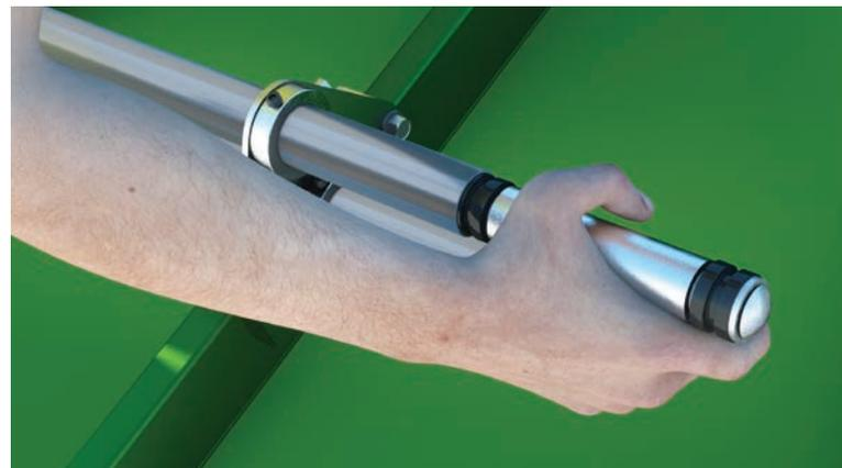
**PASO # 4** Gire la parte expuesta del cuerpo en el sentido de las agujas del reloj hasta que haya tensión entre la junta de goma y el interior de la tubería. Continuar apretando hasta que el Conector Interno no se puede sacar de la tubería.
